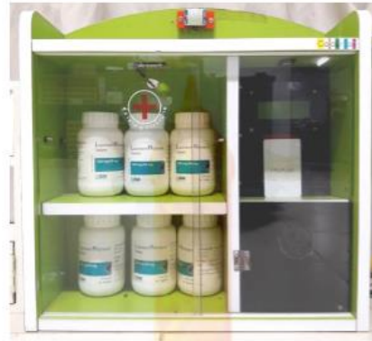
รูปที่ 5 ตู้เก็บยาอัจฉริยะสำหรับผู้สูงอายุและผู้พิการทางสายตาโดยใช้เทคโนโลยีอาร์เอฟไอดี
